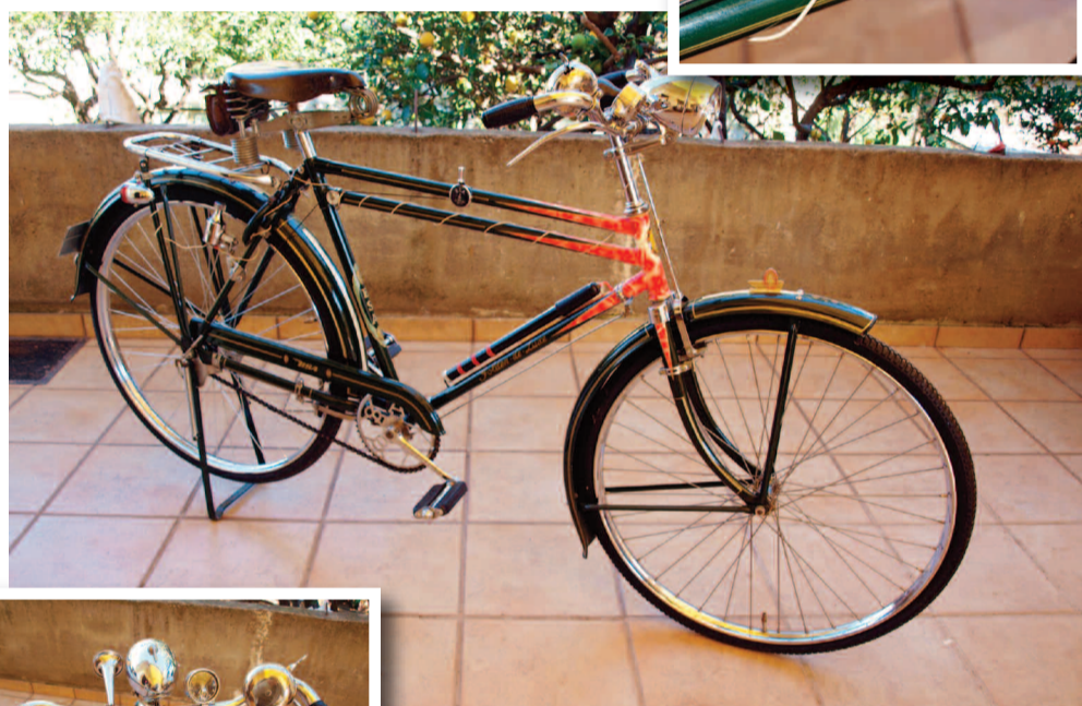
Το ποδήλατο μάρκας BSA του 1950, έχει ανακατασκευαστεί, μέχρι και την τελευταία βίδα, στην αρχική του μορφή, ενώ διαθέτει και σασμάν τριών ταχυτήτων.
