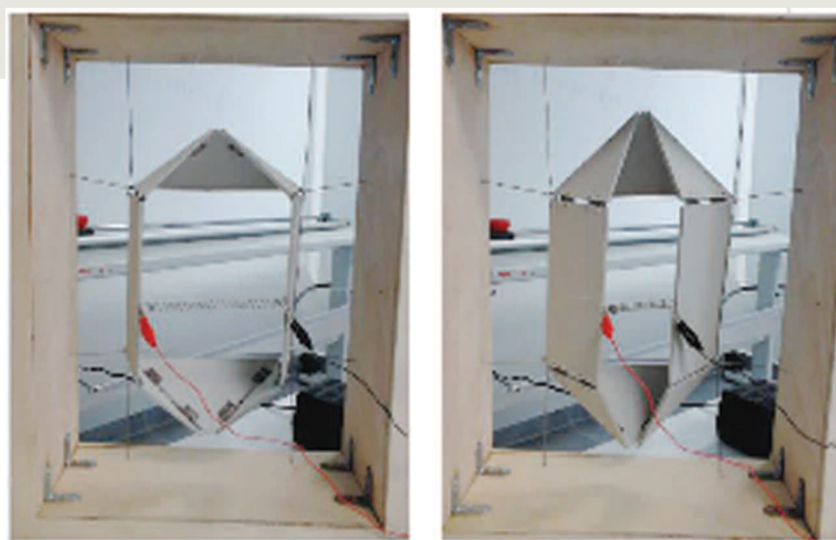
Πειράματα κίνησης του ενεργοποιητή στη μακέτα του σκιάστρου.
