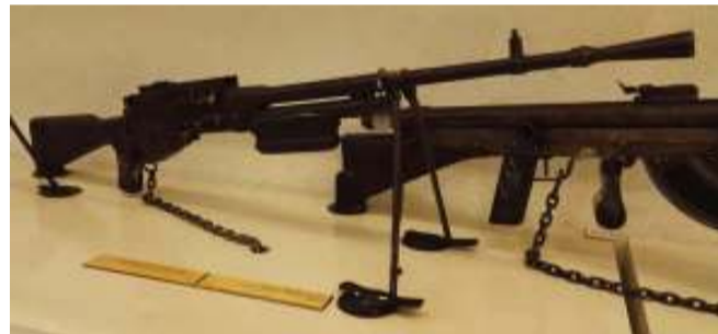
Το οπλοπολυβόλο Hotchkiss υποδείγματος 1926, των 6,5 κλστ. ήταν το καλύτερο του Ελληνικού Στρατού. Ήταν κατασκευασμένα να βάλουν το ελληνικό φυσίγγιο των 6,5 κλστ. το ίδιο φυσίγγιο που έβαλε και το βασικό τυφέκιο του Ελληνικού Στρατού.
